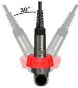
中间 1 1/4 " NPS 直管螺纹固定； 直立安装或斜向安装不大于 30 度倾角 工作正常
