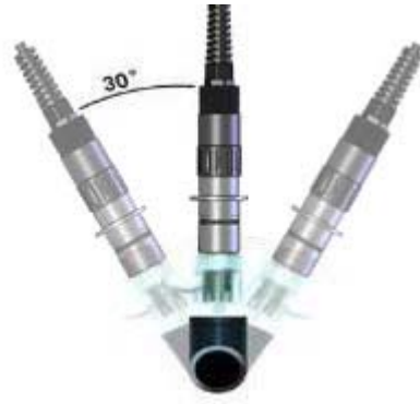
下端 3/4 " NPT 锥螺纹固定； 直立安装或斜向安装不大于 30 度倾角 工作正常
