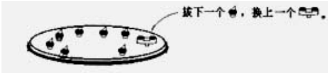
图 3.2 双头指针替换原水表指针
